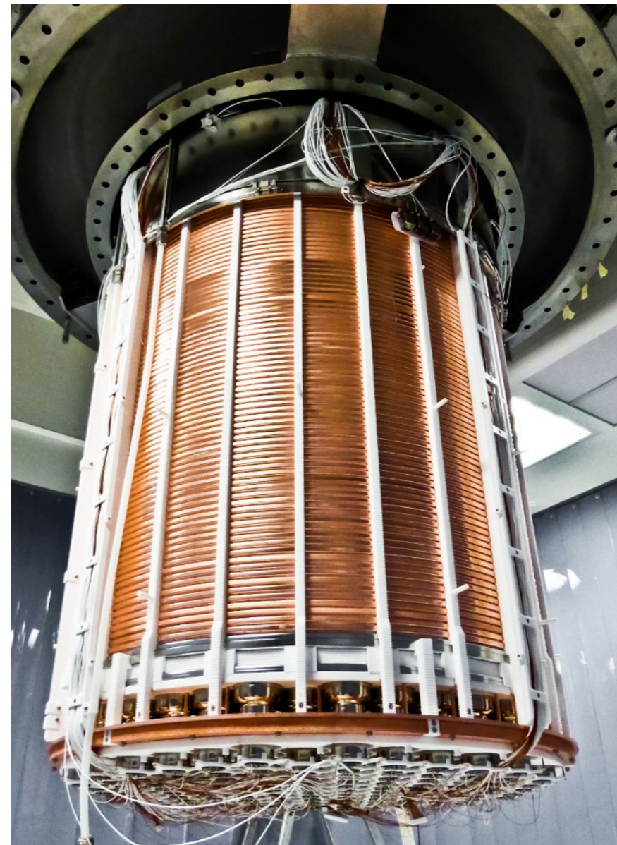
XENON1t @ LNGS 2000 kg of LXe
