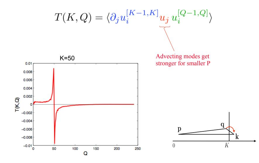
$$T(K,Q) = \langle \partial_j u_i^{[K/2,K]} u_j u_i^{[Q/2,Q]} \rangle$$
