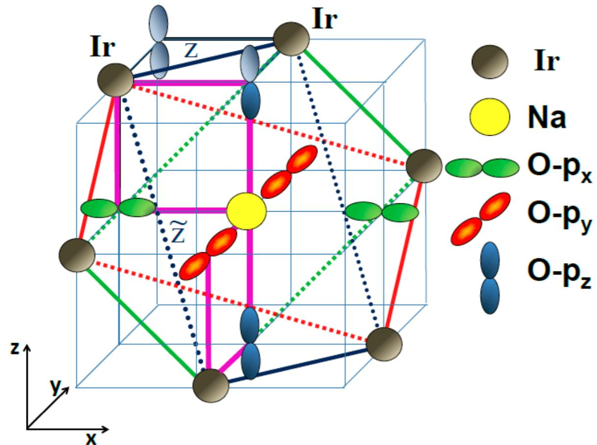
Path 1 :  $\text{Ir}(Y) \rightarrow \text{O}(p_z) \rightarrow \text{Na}(s) \rightarrow \text{O}(p_z) \rightarrow \text{Ir}(X)$
